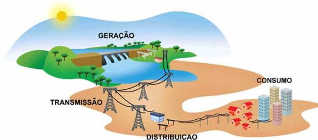
Figura 39 – Segmentos da indústria de energia elétrica Fonte: Associação Brasileira de Distribuidores de Energia (ABRADEE)
